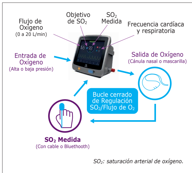
Figura 4. Principios operativos del ajuste automatizado de oxígeno por FreeO 2 . Una fuente de oxígeno (baja o alta presión) está conectada a la FreeO 2 y el oxígeno fluye a una velocidad entre 0 y 20 L/min, dependiendo de la diferencia entre la SO 2 medida y la SO 2 objetivo. Los ajustes de flujo de oxígeno se realizan cada segundo. Además de la titulación y el destete automatizados, el sistema permite el monitoreo continuo del flujo de oxígeno, la SO 2 , la frecuencia cardíaca y la frecuencia respiratoria. También se utilizan tendencias en estos parámetros y otros parámetros de monitoreo.
